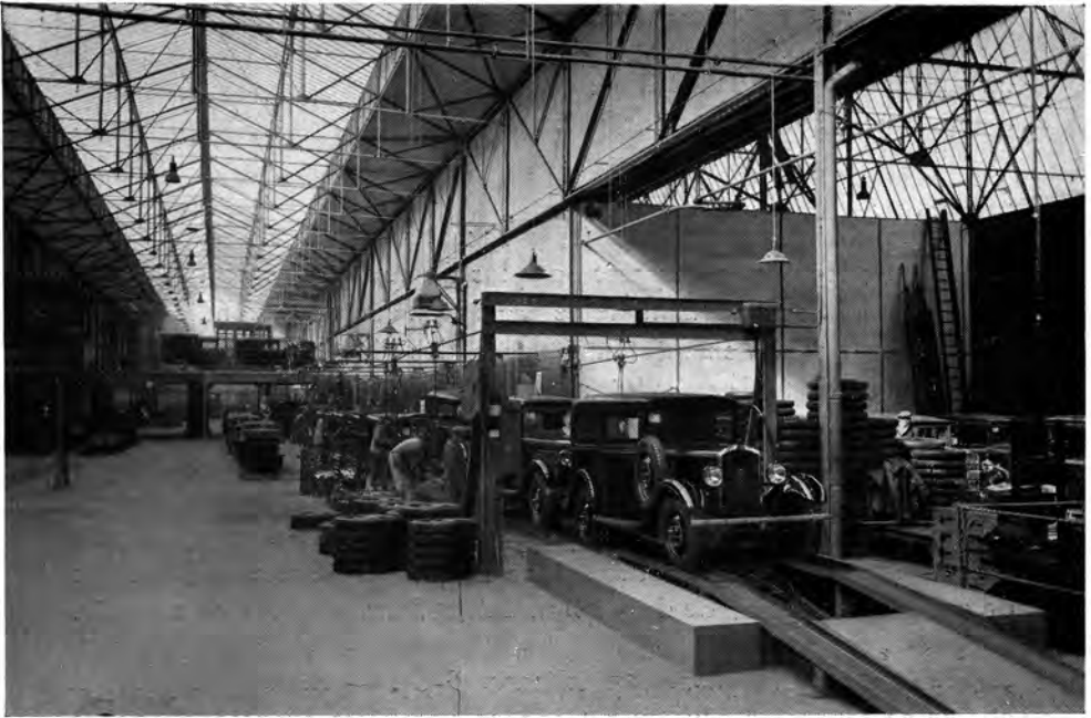
Carrosserie Chaîne de montage des voitures
