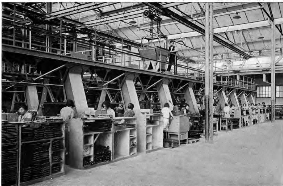
Fonderie Fabrication des noyaux
