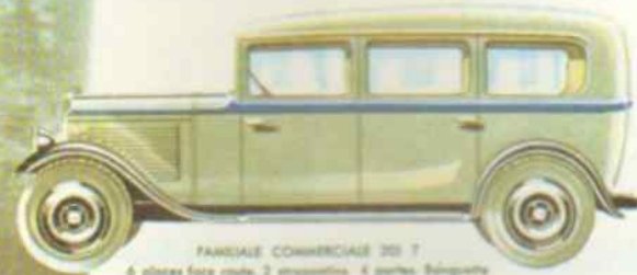
CONDUITE INTÉRIEURE NORMALE 201 4 portes, 4 places. Garniture drop. Pare-brise de sécurité. Essuie-glaces automatique. Pédalier. (Voir caractéristiques communes à toutes les 201.)
