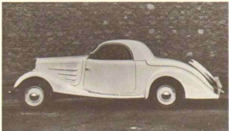
Coupé transformable Éclipse 401 D à décapotage électrique, système Paulin.
