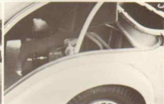
Coupé transformable 601 D, détail des opérations du décapotage automatique et détail de la tringlerie interne animée par un moteur électrique.
