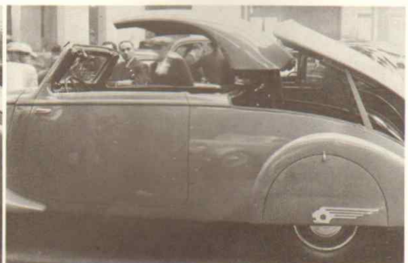
Coupé transformable 402 à commande électrique ; détail des opérations du décapotage automatique.
