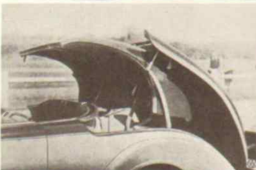
Coupé transformable 601 D, détail des opérations du décapotage automatique et détail de la tringlerie interne animée par un moteur électrique.
