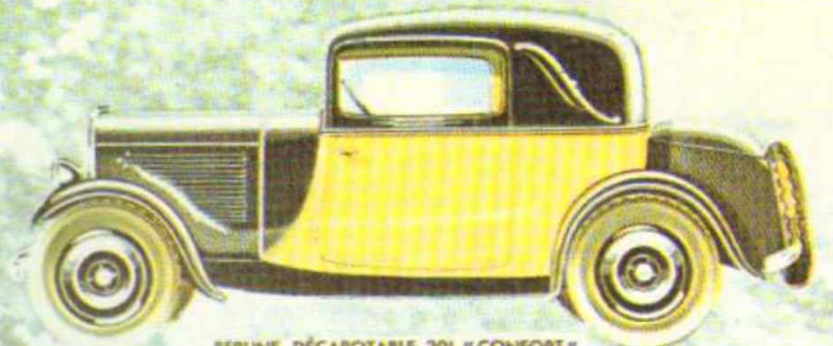
BERLINE DÉCAPOTABLE 201 "CONFORT" 2 portes. 2 sièges AV réglables. 2 places Intérieures. Grande malle avec 2 soufflets et tiroir à outils. Toutes glaces de sécurité. Enjoliveurs. Projecteur pare-brise. Garniture drap pure laine 1 er choix. (Livrable aussi avec capotage fixe.) (Voir caractéristiques communes à toutes les 201 "Confort".)
