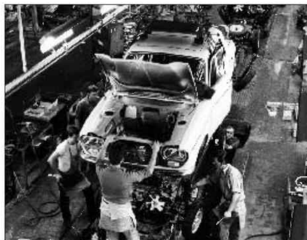
Descente des carrosseries de 204 sur les organes mécaniques.
