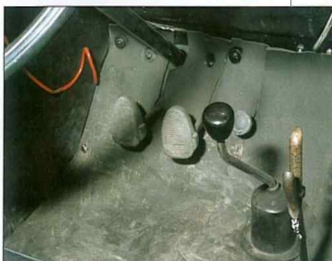
Le levier de vitesses n'est pas très ergonomique, tout autant que les pédales. Mais on s'habitue très vite au double débrayage et aux mouvements amples.
