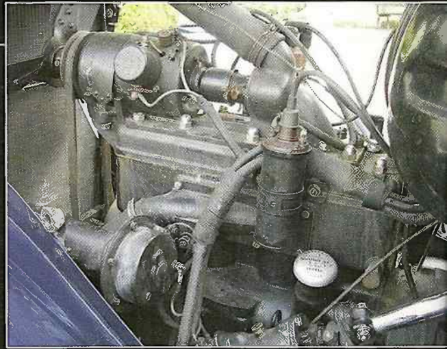
La poulie de dynamo entraîne les pales du ventilateur, la dynamo et la pompe à eau.
