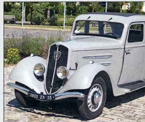
Les trois séries de fentes d'aération permettent de différencier au premier coup d'œil une 201 M d'une 201 D.
