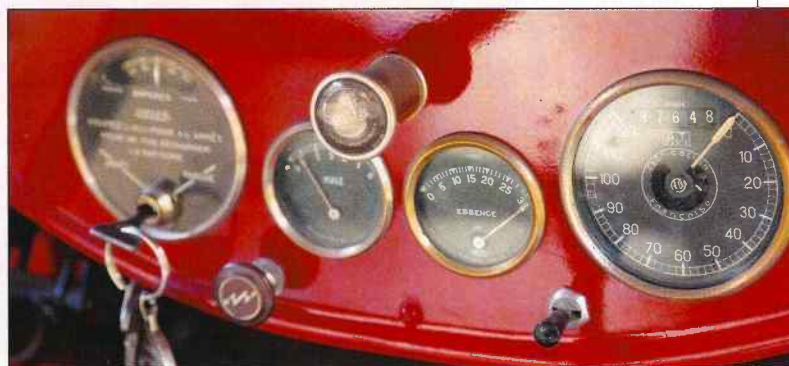
La console en tôle laquée regroupe une instrumentation simple et lisible : ampèremètre, huile, essence et compteur de vitesse.
