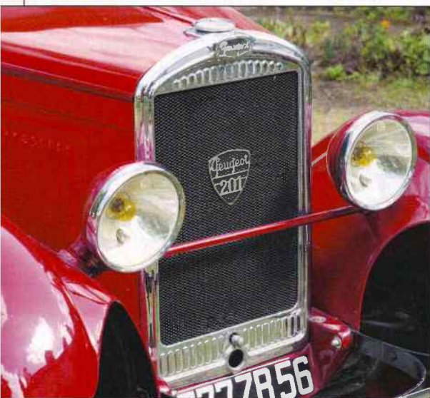
Les deux premiers millésimes s'identifient au premier coup d'œil à leur calandre dépourvue de grille frontale, laissant apparaître les nids-d'abeilles du radiateur.
