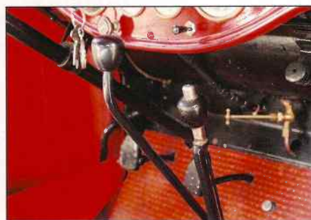
A gauche, le levier de commande des trois vitesses. A droite, le frein de parking.
