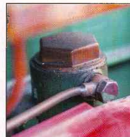
Le moteur de la 201 comporte un filtre à huile. Bien vu !
