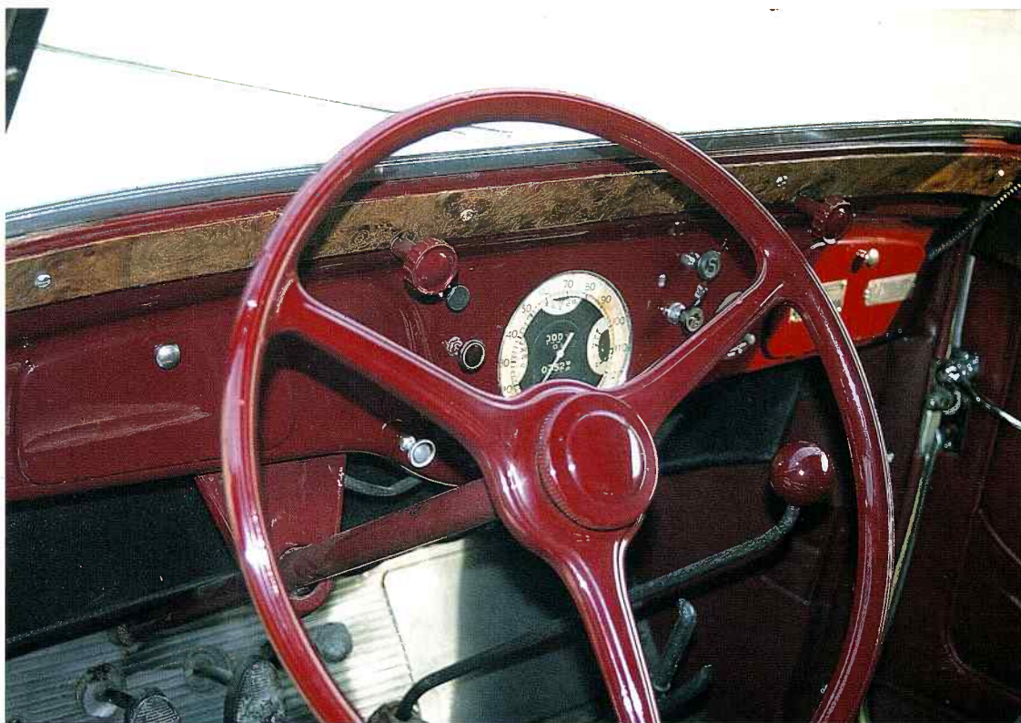
▲ La planche de bord est typique des voitures des années trente. Elle comprend un module central intégrant toutes les informations mécaniques nécessaires. La généreuse mollette au centre sert à l'ouverture progressive du pare-brise. L'air conditionné est encore un rêve d'ingénieur à cette époque !
