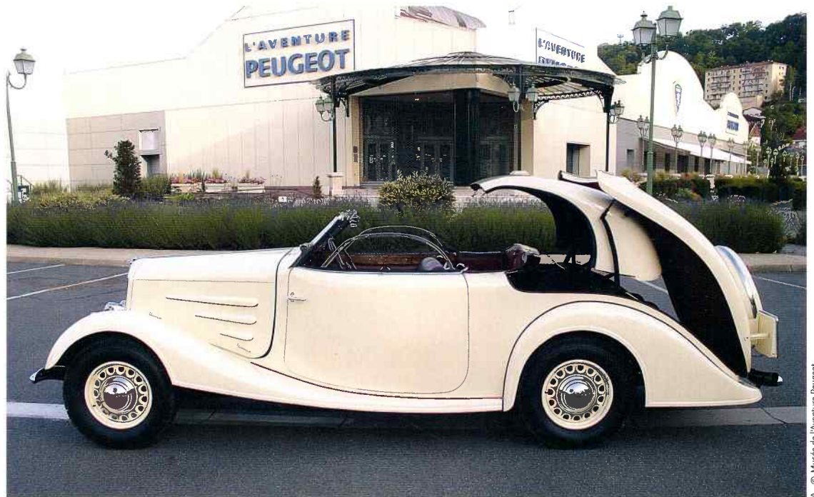
▲ Le défaut majeur du dispositif Eclipse demeure la faible contenance de la malle à bagages une fois le pavillon replié. Cet exemplaire, qui prend la pose devant le très intéressant Musée de l'Aventure Peugeot à Sochaux, repose sur des roues à voile ajouré disponibles dès l'été 1935.
