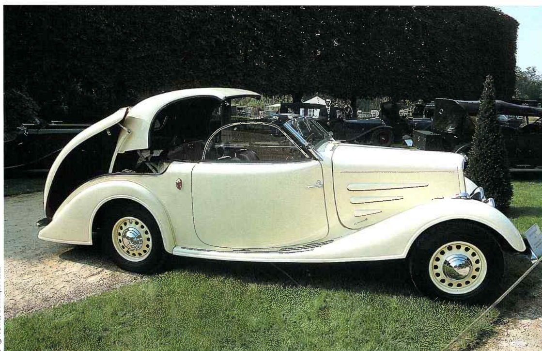
▲ Voici comment se présente l'opération de décapotage ou capotage à mi-chemin. L'opération est facilitée pour le moment par un moteur électrique. On observe la belle forme galbée vers l'arrière des glaces latérales.
