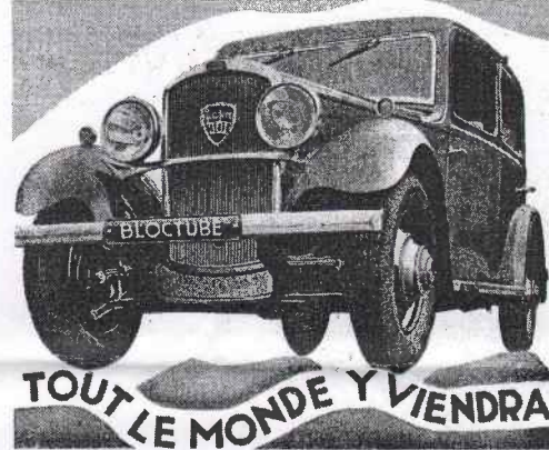
Au cours de l'hiver 1932-33, la 301 profita d'une légère modification de calandre qui permet une identification facile: les trois barrettes horizontales (à gauche) disparurent et les barrettes verticales (ci-dessus au centre) se resserrèrent; cette évolution est très visible sur la publicité de droite parue en mars 1933 à l'occasion du Salon de Genève.
