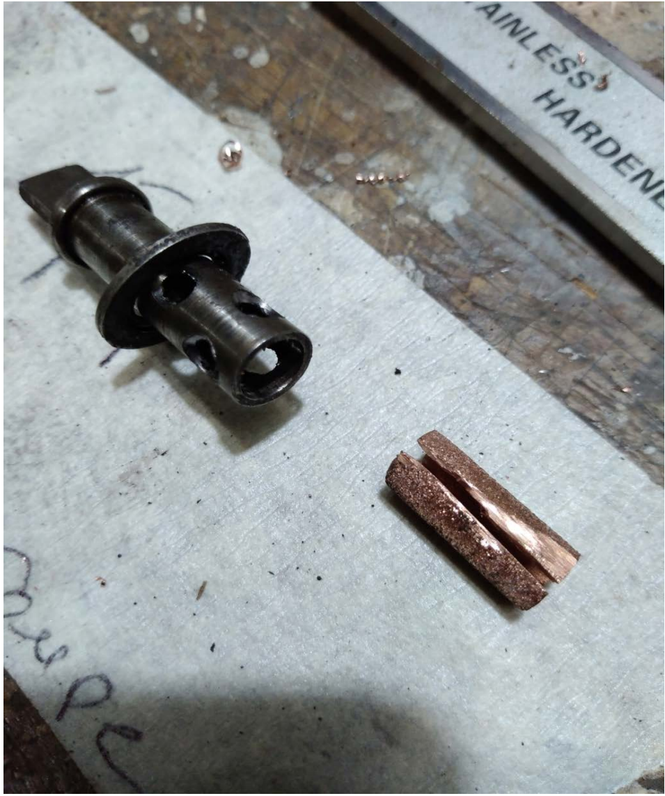
Le tournevis modifié prêt à accueillir le flexible neuf.
