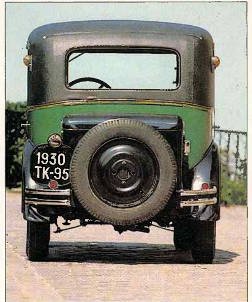
C'est là que la 201 s'exprime le mieux : sur route plate et à 75 km de vitesse de croisière. Avec cette grande lunette arrière, Peugeot changeait les habitudes des chauffeurs, de l'esthétique et optimisait également l'usage du rétroviseur.
